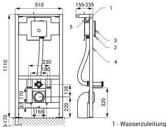
Abmessung Edelstahlabdeckplatte Abmessung Unterputz-Mauerkasten Abmessung Montagerahmen
