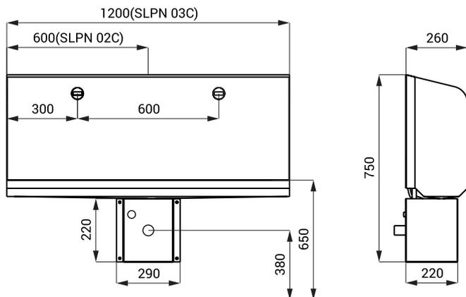
\* für die Höhe der Vorderkante des Urinals 650 mm über dem Boden
