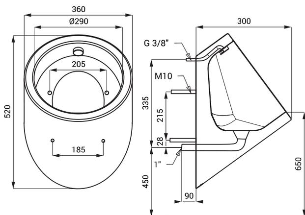
\* für die Höhe der Vorderkante des Urinals 650 mm über dem Boden
