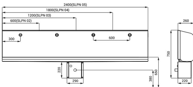
\* für die Höhe der Vorderkante des Urinals 650 mm über dem Boden
